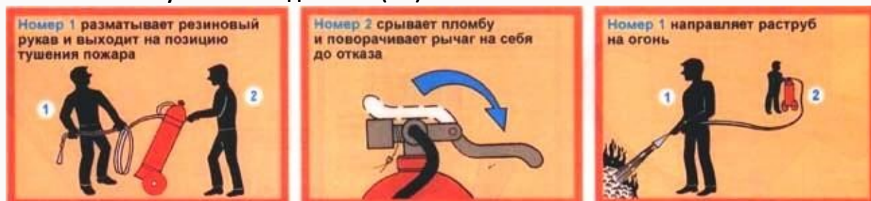
Рис. 8.13. Принцип действия углекислотного огнетушитель передвижного типа
