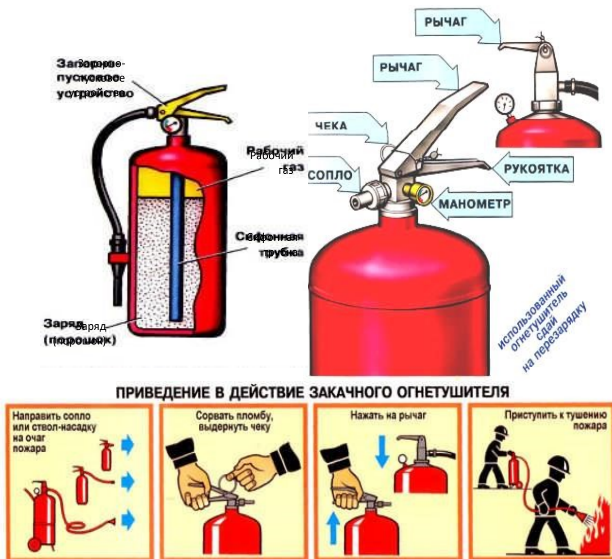
Рис. 8.4. Принцип действия закачного порошкового огнетушителя
