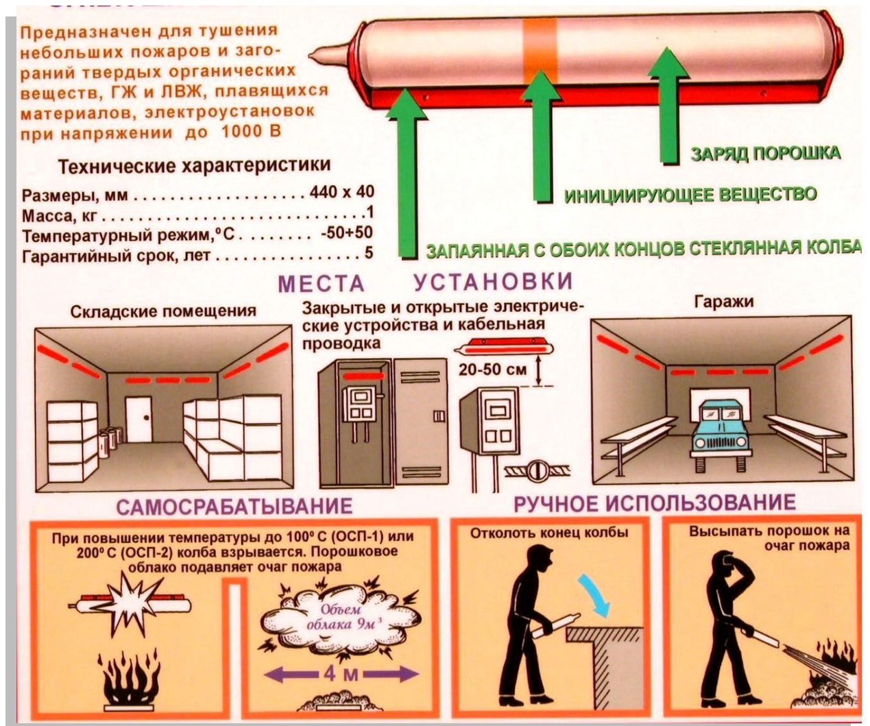
Рис. 8.15. Принцип действия самосрабатывающего огнетушителя
