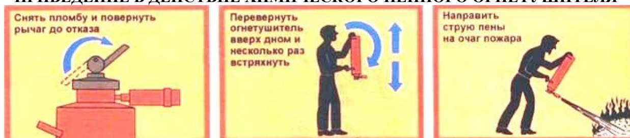
Рис. 8.8. Принцип действия химического пенного огнетушителя типа ОХП
