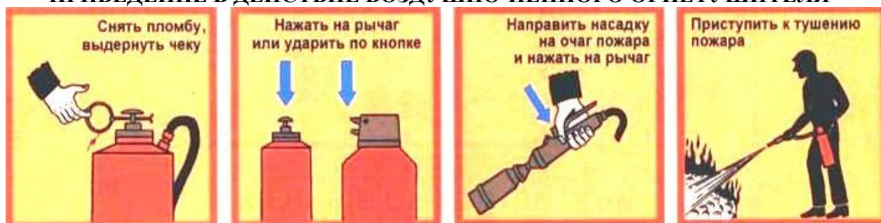
Рис. 8.9. Принцип действия воздушно-пенного огнетушителя типа ОВП
