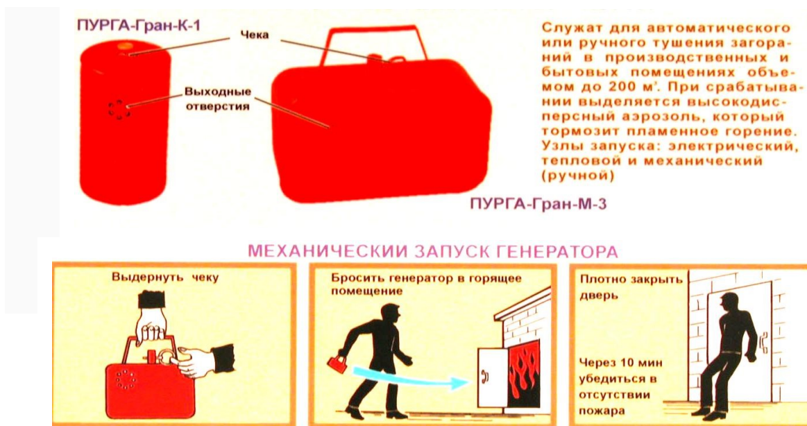
Рис. 8.17. Принцип действия аэрозольных генераторов ручного действия
