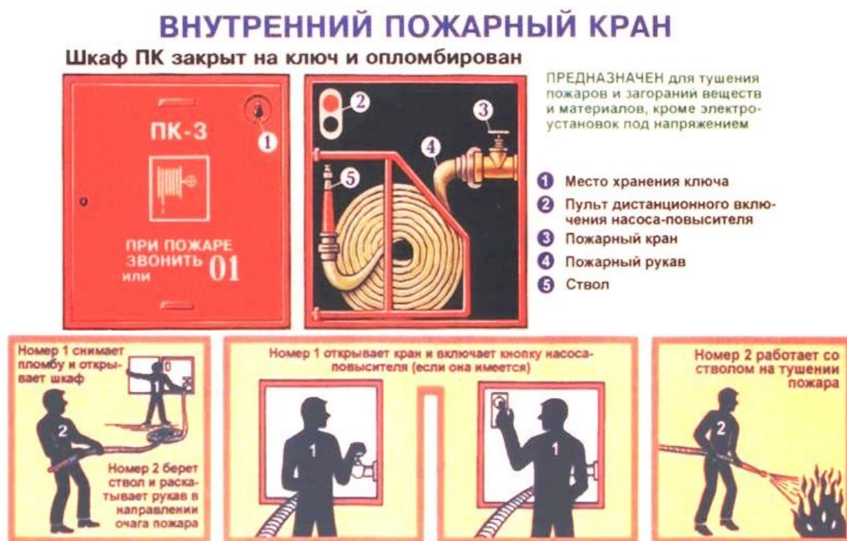
Рис. 8.3. Внутренний пожарный кран и действия при пожаре
