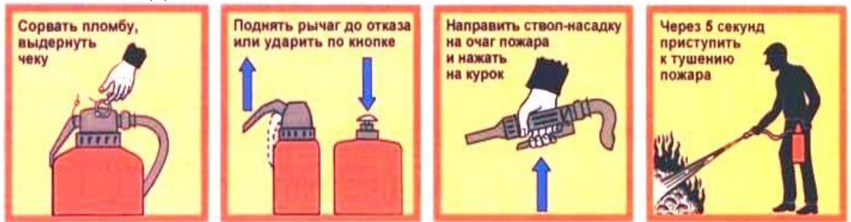
Рис. 8.5. Принцип действия огнетушителя со встроенным источником давления
